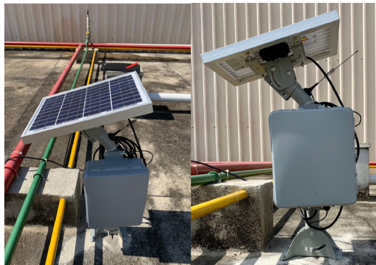
GeoSan IoT - realiza o monitoramento para prevenção de perdas e vazamentos de água
