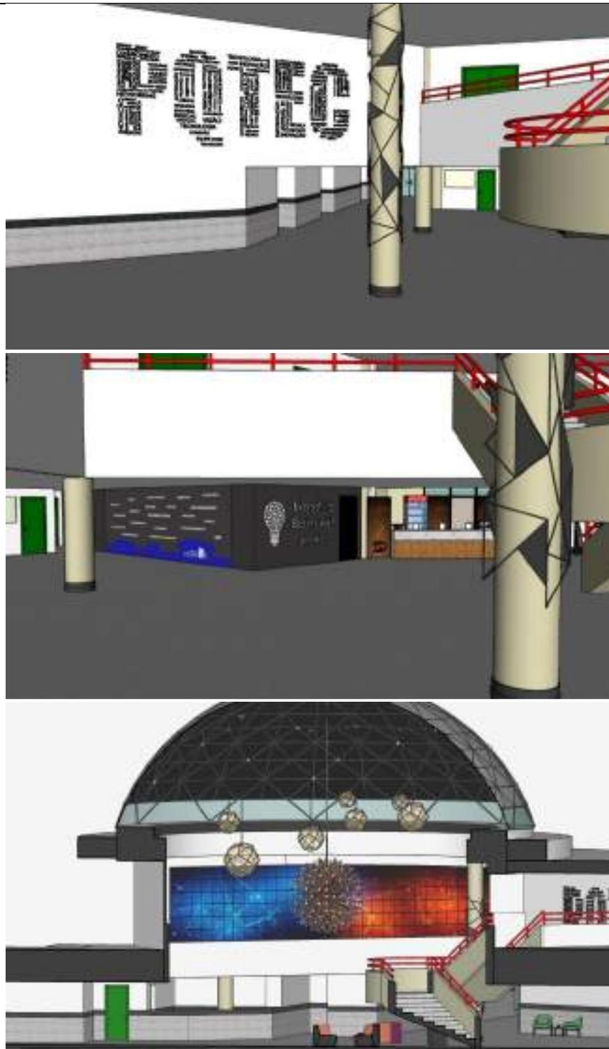
Projeto consta a instalação de painéis de Tv, instalação de luminárias redondas que representam o sistema solar, sendo uma delas diferenciadas representando o Sol e os demais os planetas. Instalação de pontos de led nos pontos de encontro das tubulações, para representação das estrelas. Pintura da cúpula e tubulação de preto. Estrutura metálica em
