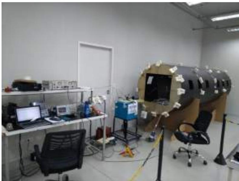
*Gerador 1,2/50us e a rede de acoplamento desenvolvido.*
