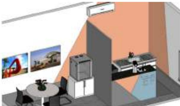
Projeto para melhoria da acústica, foi colocada 14 nuvens acústicas, 33 painéis acústicos na parede, 02 quadros, painéis de jardim vertical, placas de osb de pinus, adesivo na área do café, 01 vaso de planta, e pintura na parede.
