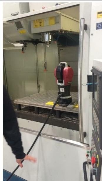
*Calibração da Máquina Romi 4 eixos D1500 com equipamento da API (parceria).*
