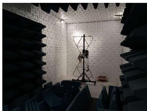
Câmara Anecóica – Instalação. e Teste de Uniformidade de Campo elétrico.
